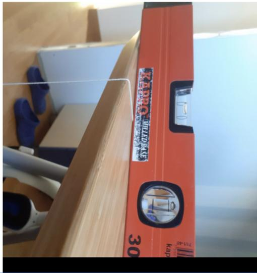
Ho semplicemente utilizzato la gravità. La scrivania è perfettamente in piano e ho legato un peso al filo. In questo modo di forma un angolo di 90 gradi
